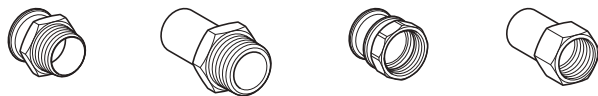
Figura 92: Transiciones Geberit Mapress Cobre con rosca hembra y transiciones con rosca macho
